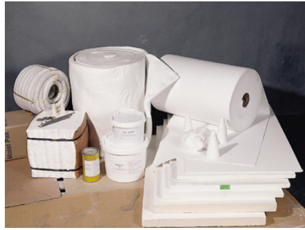
Resim 1.21: Kağıt tipi seramik yünü malzemeler
